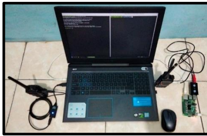
Gambar 6. Pengujian OFDM Raspberry Pi 4 dan Laptop menggunakan HT
