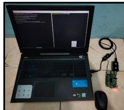
Gambar 5. Pengujian OFDM Raspberry Pi 4 Direct ke laptop
